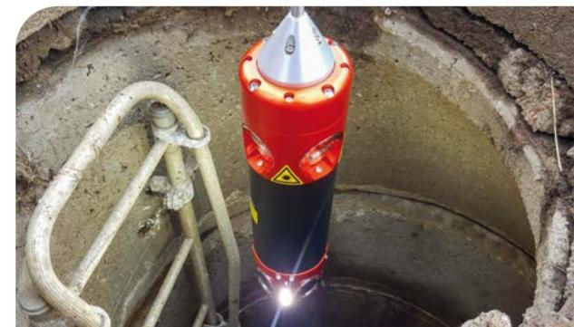
Hohe Produktivität und gute Bildqualität sind entscheidend für die Schachtinspektion. CleverScan ist ein mobiles und vollautomatisches panoramabasierendes Schacht-Inspektionssystem, welches mit dem integrierten Prozessor und einem kompletten Betriebssystem große Mengen von hochauflösenden Bild- und Sensordaten direkt verarbeiten kann.
